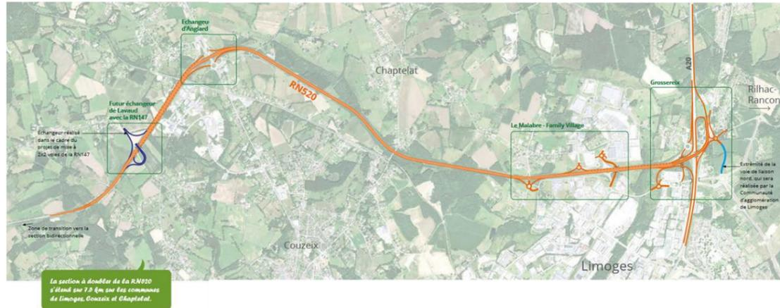
Figure 35 - RN520 – Aménagement du contournement nord de Limoges entre l’A20 et la RN147<sup>24</sup>
