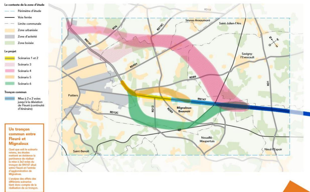
Figure 261 : Aménagement de l'entrée Sud-Est de Poitiers -vue d'ensemble des six scénarios d'aménagements
