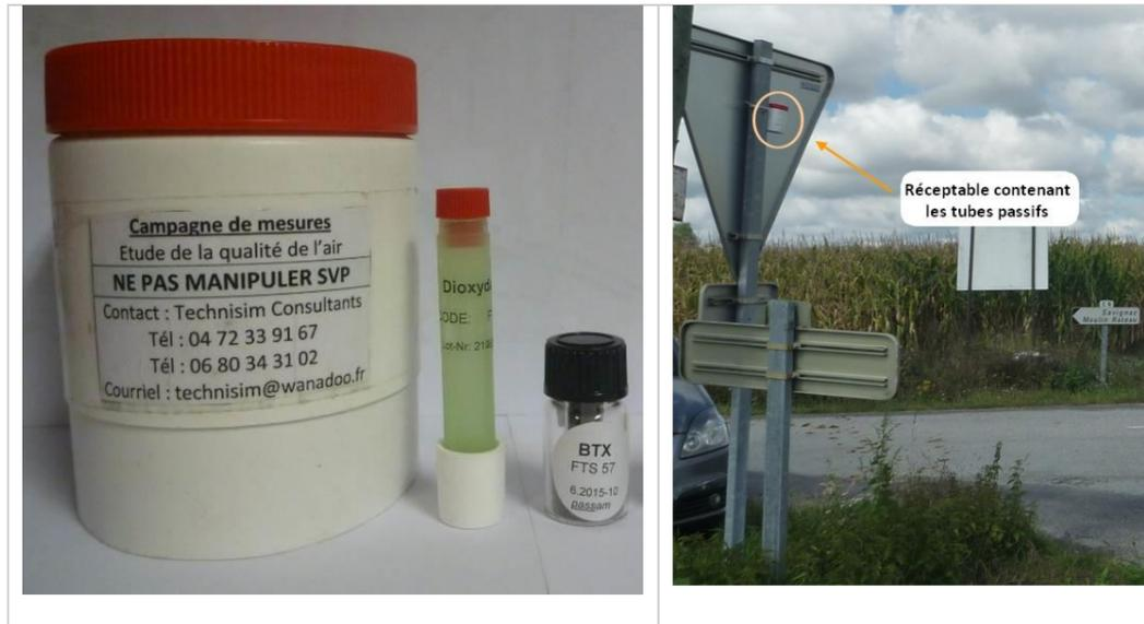
Figure 228 : Dispositifs d'échantillonnage passifs
